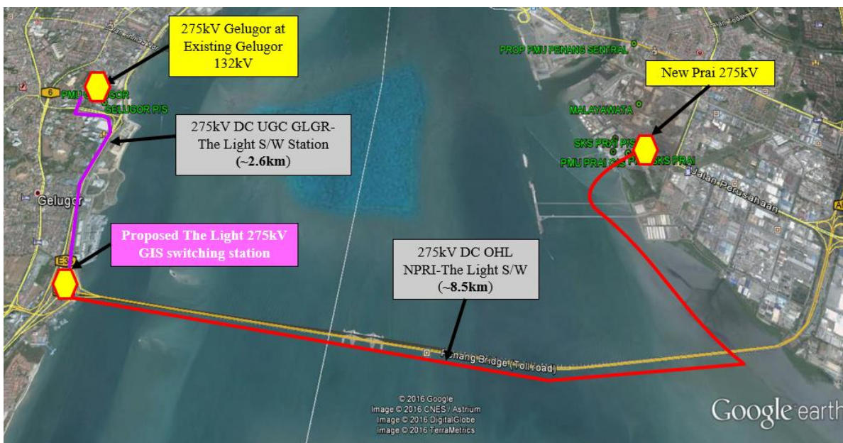
Jajaran Sambungtara Talian Atas 275kV dari Stesen Janaelektrik Perai ke PMU The Light, Batu Uban di Sepanjang Jambatan Pulau Pinang.
