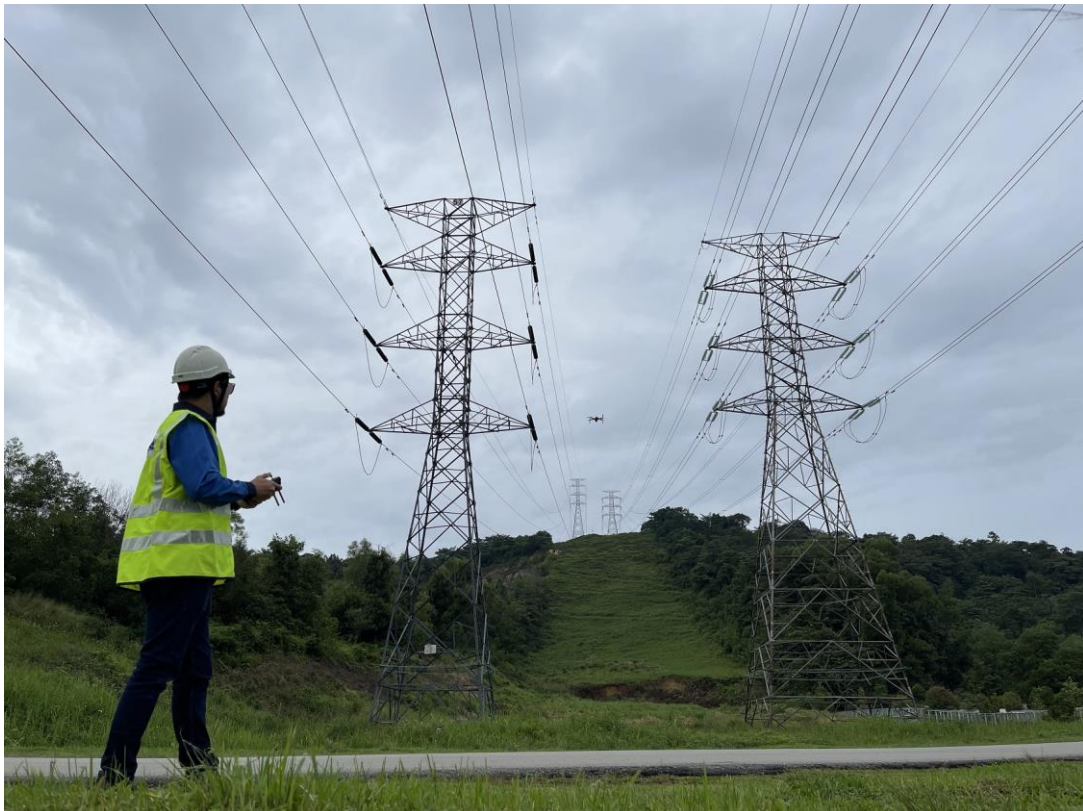
Seorang juruteknik sedang melakukan "takeoff" untuk memulakan misi pencerapan data imej udara bagi tujuan kajian cadangan talian baharu.
